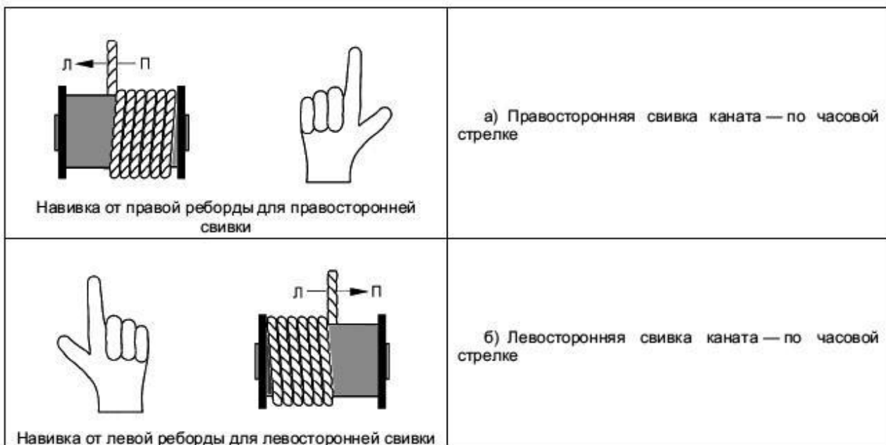
Рисунок А.1 - Правильный метод определения направления навивки и места крепления каната на барабане
